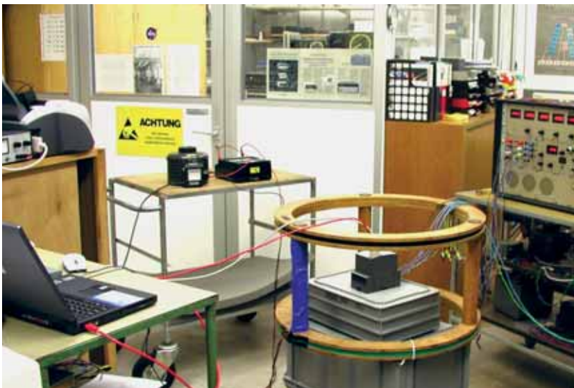
Bepalen van het gedrag van apparatuur onder de invloed van een extern magnetisch veld, dat met een Helmholtz-spoel wordt opgewekt.
